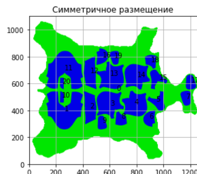
Рис. 5. Симметричное размещение набора деталей обуви
