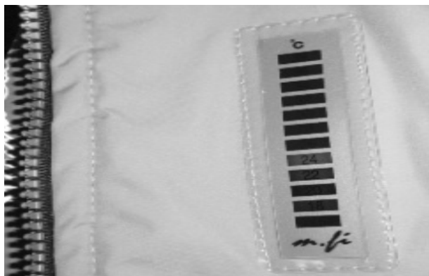
Рис. 2. Датчик контроля температуры, закрепленный на подкладке многослойной одежды
