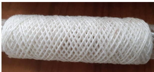
Рис. 2. Структура 23-замкнутой намотки полипропиленовых нитей
