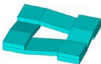
Рис. 5. Конечно-элементное представление ячейки периодичности ткани полотняного переплетения [4]
