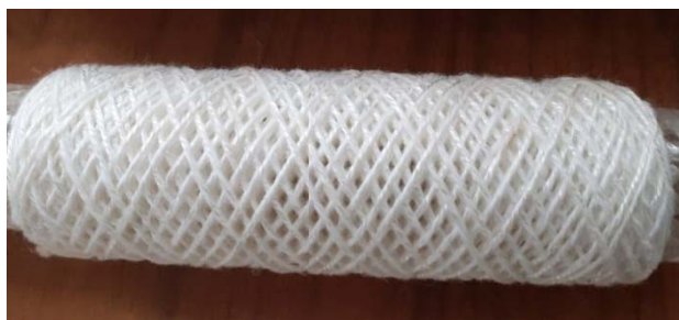
Рис. 2. Структура 23-замкнутой намотки полипропиленовых нитей
