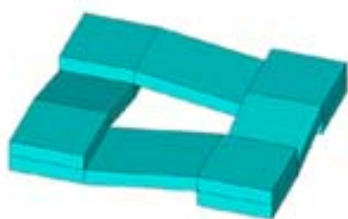
Рис. 5. Конечно-элементное представление ячейки периодичности ткани полотняного переплетения [4]
