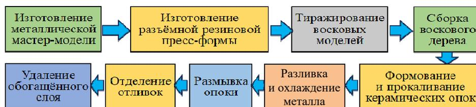
Рис. 2. Базовая технология ЛВМ
