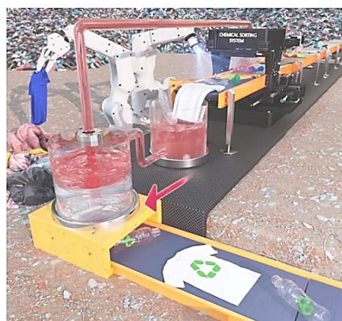
Рис. 2. Химическая сортировка для выборочного сбора полиэстера из отходов пластмасс и текстиля [18]
