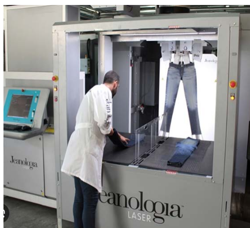
Рис. 1. Лазерная обработка джинсовых брюк от компании “Jeanologia” [15]
