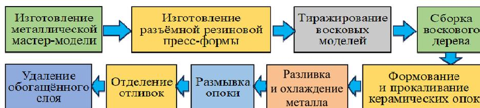
Рис. 2. Базовая технология ЛВМ
