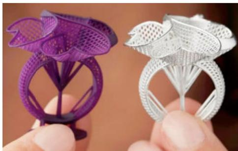
Рис. 6. Восковая модель, спроектированная по технологии 3D-моделирования ювелирных изделий и изготовленная на 3D-принтере (слева), и готовое изделие (справа) [8]
