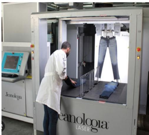
Рис. 1. Лазерная обработка джинсовых брюк от компании “Jeanologia” [15]
