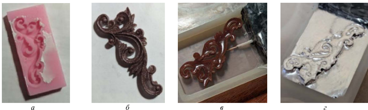
Рис. 1. Форма для заливки из силикона (а); образец в виде сложнопрофильного вензеля из эпоксидной смолы (б); форма для заливки галлия (в); модель из галлия, предназначенная для негативного наращивания меди (г)
