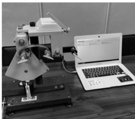
Рис. 4. Разрывная машина
