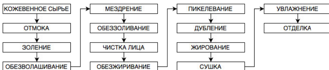
Рис. 2. Последовательность технологических операций получения кожевненного полуфабриката по традиционной технологии
