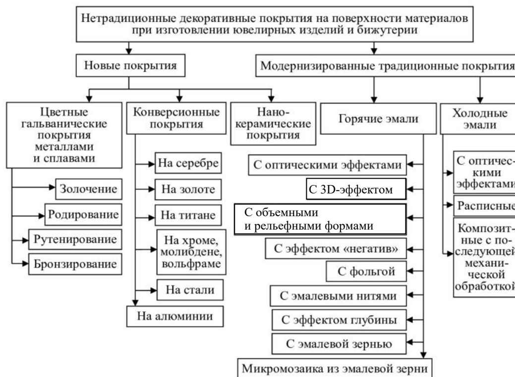
Рис. 2. Нетрадиционные декоративные покрытия на поверхности материалов при изготовлении ювелирных изделий и бижутерии
