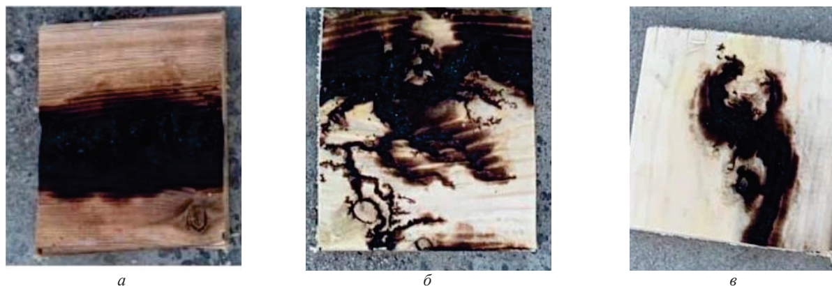
Рис. 5. Обработанные образцы: а – ель северная (4 мин); б – сосна (3 мин); в – лиственница (3 мин)
