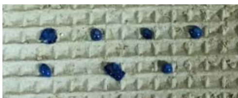
Рис. 16. Формирование зерни из кусочков эмали неудачной формы
