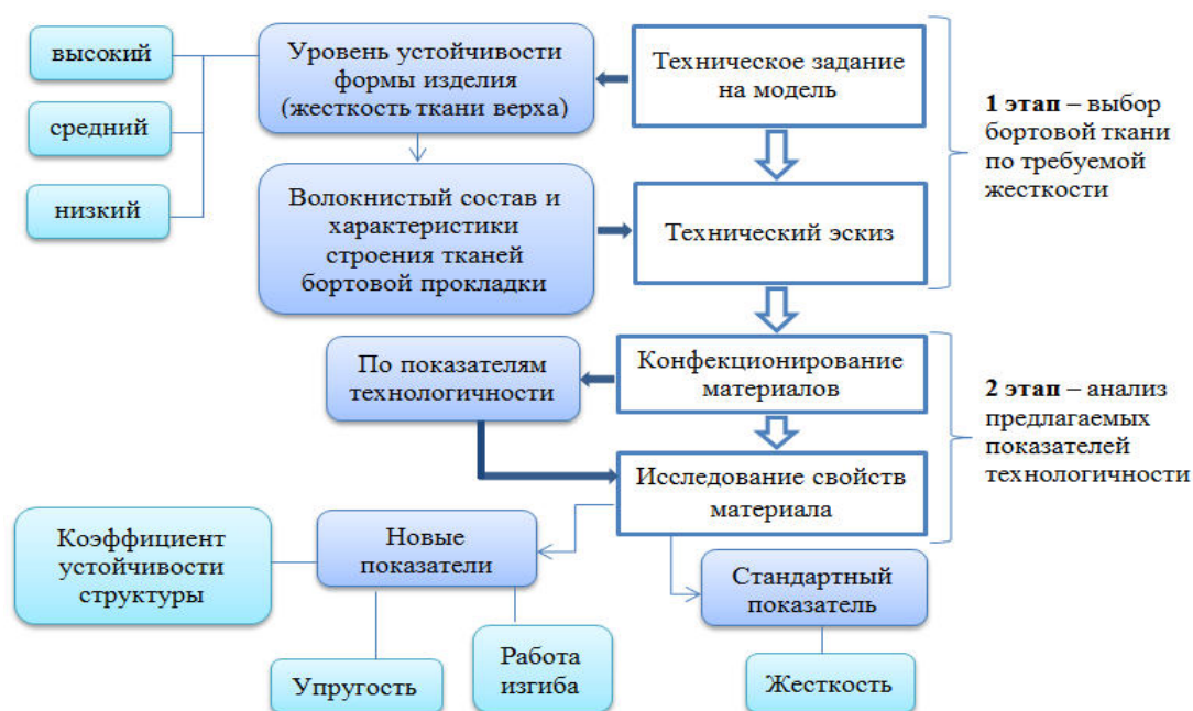
Рис. 3. Алгоритм конфекционирования бортовых тканей
