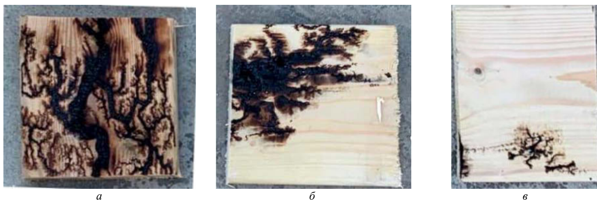
Рис. 6. Обработанные образцы: а – ель северная (2 мин); б – сосна (2 мин); в – лиственница (1,5 мин)
