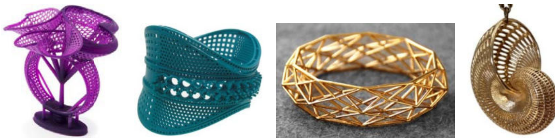
Рис. 2. Модели и ювелирные отливки от 3D Services [6]
