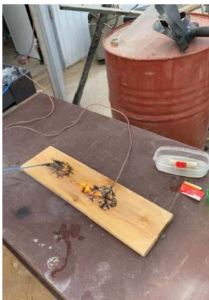
Рис. 3. Образование фигур Лихтенберга
