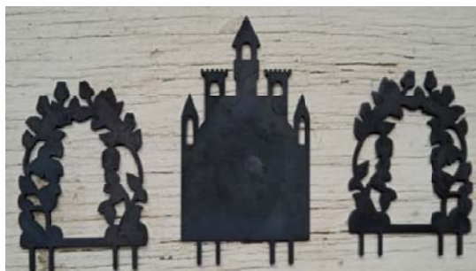
Рис. 5. Вороненные стальные заготовки для черной шахматной фигуры
