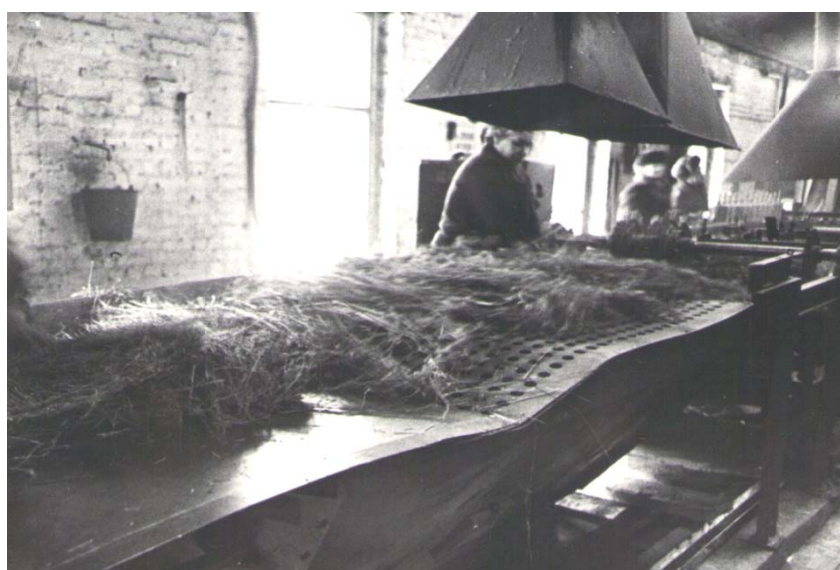
Рис. 3. Опытный конвейерный стол сортировки на Палехском льнозаводе
