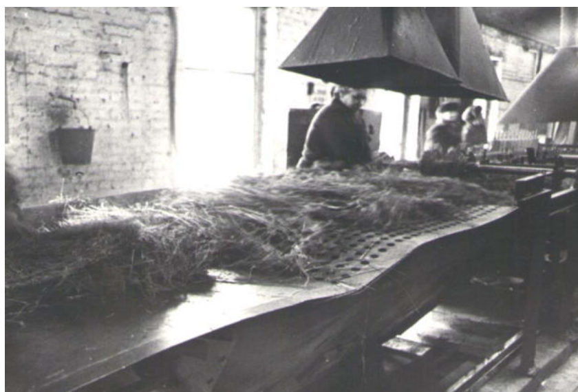
Рис. 3. Опытный конвейерный стол сортировки на Палехском льнозаводе
