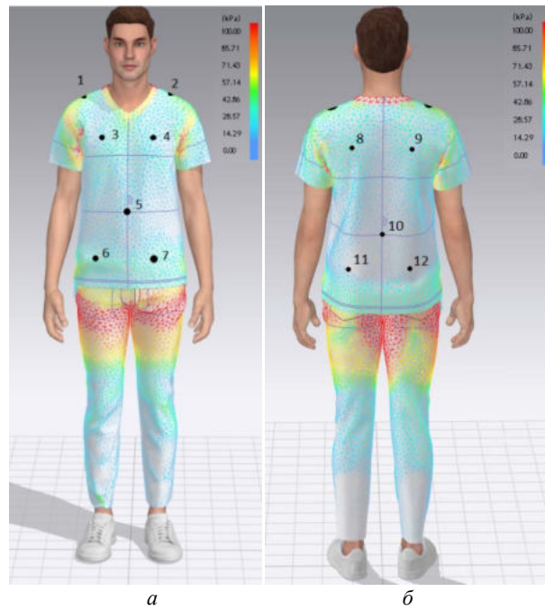
Рис. 5. Распределение поля напряжений в материале в структуре изделия: а – на передне изделия; б – на спинке изделия
