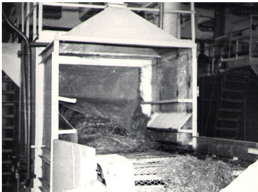
Рис. 1. Вынос пыли и частиц костры у открытого выходного отверстия сушильной машины
