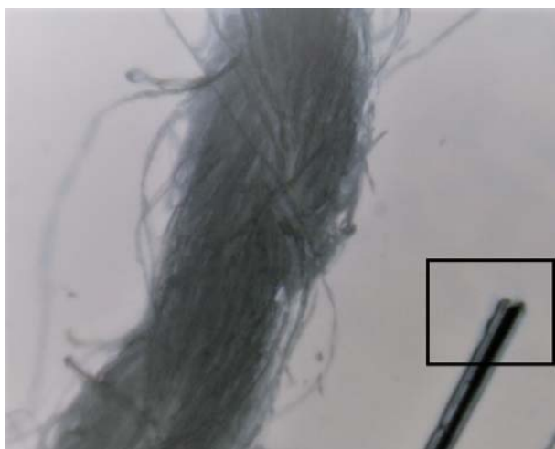
Рис. 4. Место обрыва ферромагнитного микропровода
