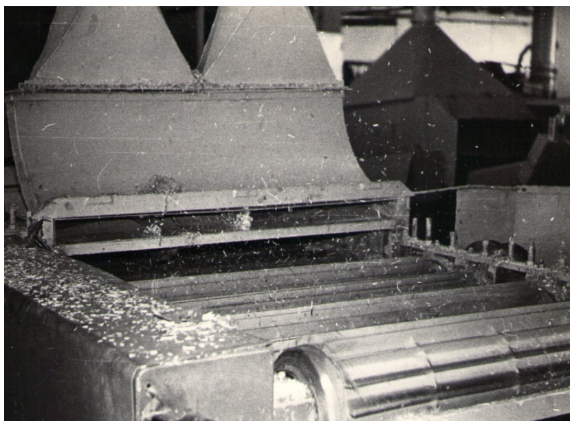
Рис. 2. Вынос пыли и частиц костры из-под укрытия у трепальной машины
