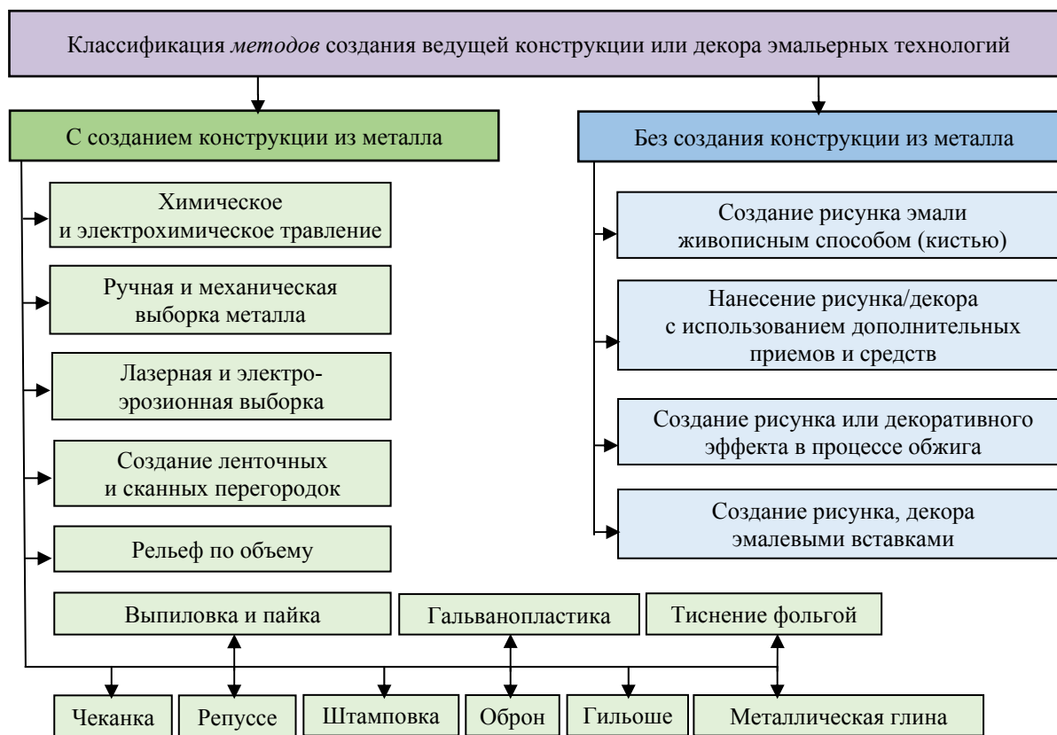
Рис. 4. Классификация методов создания ведущей конструкции или декора эмальерных технологий
