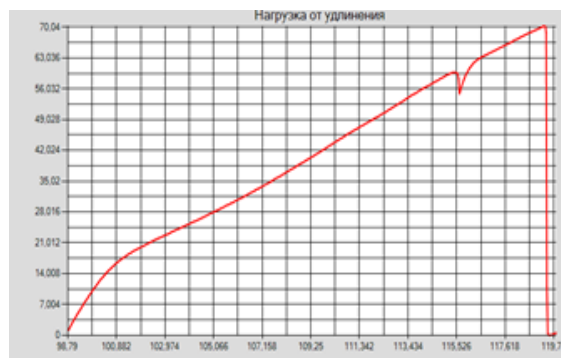
Рис. 1. Фрагмент протокола испытаний с диаграммой растяжения
