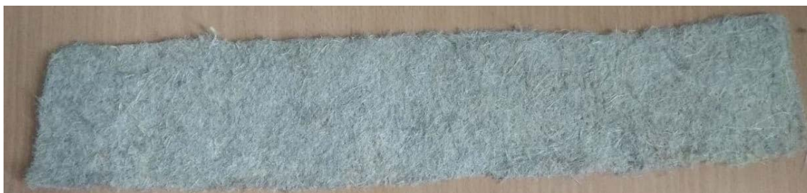
Рис. 1. Образец нетканого материала, полученного иглопробивным способом
