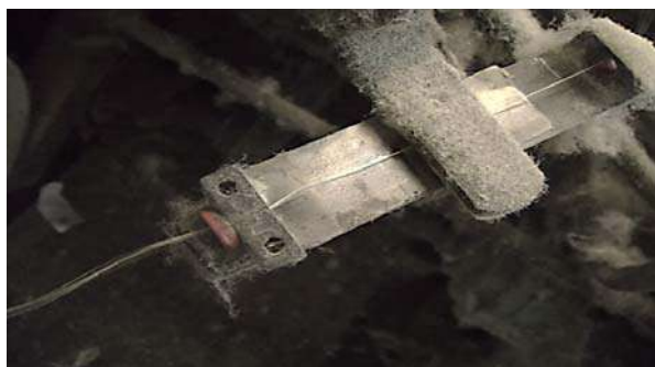
Рис. 1. Тормоз уточной нити с установленным стальным вкладышем
