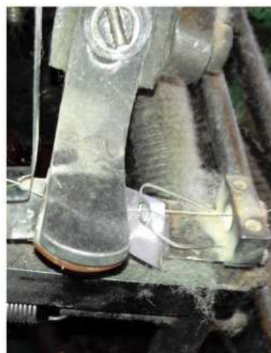
Рис. 3. Тормоз уточной нити с установленными ламелью и ограничителем поперечного движения уточной нити
