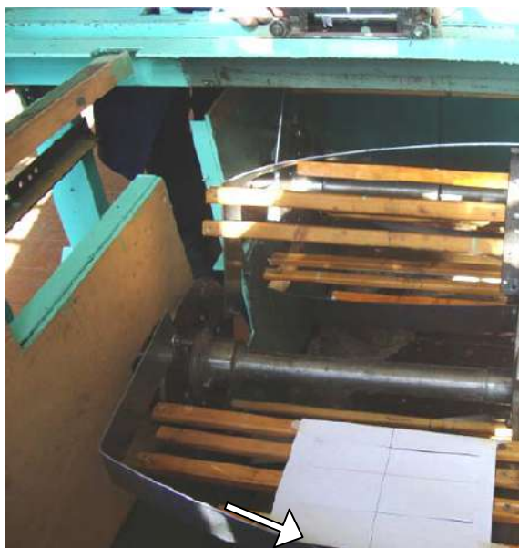
Рис. 2. Расположение листа бумаги для отпечатков ленты на подбильной решетке била трепального барабана
