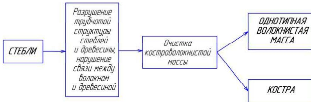
Рис. 1. Схема технологического процесса получения однотипного волокна
