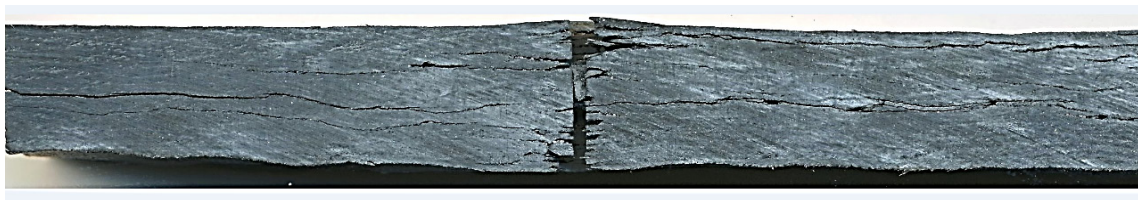
Рис. 2. Пример образования трещины после пробоя на станке ГАР в образце углепластика толщиной 8 мм давлением 400 МПа
