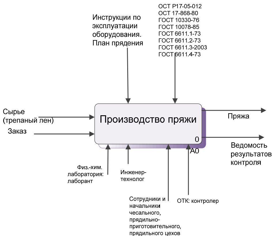
Рис. 1. Контекстная диаграмма модели «как есть» управления качеством технологического процесса получения пряжи
