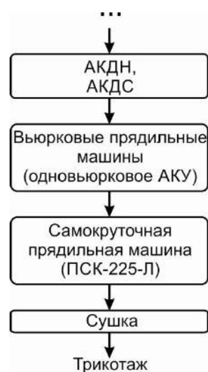
Рис. 4. Технология скручивания вьюрковой пряжи самокруточным способом
