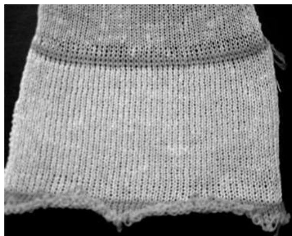
Рис. 6. Образец трикотажного полотна, полученный из крученой вьюрковой пряжи
