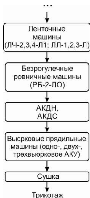
Рис. 3. Технология выработки льняной пряжи вьюрковым способом с применением безрогулечных ровничных машин
