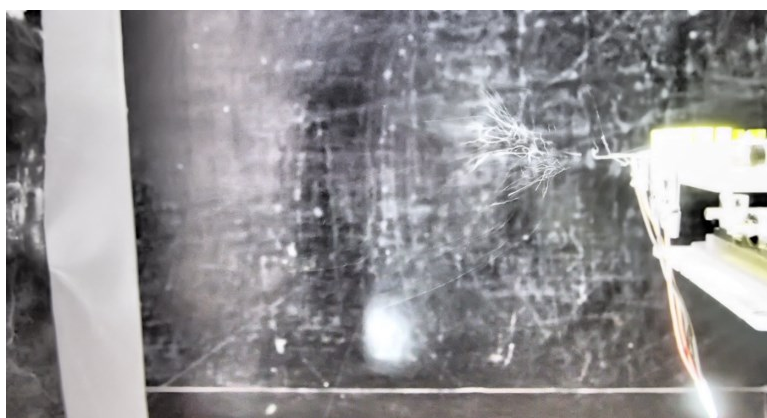
Рис. 4. Процесс электроформования на разработанной установке
