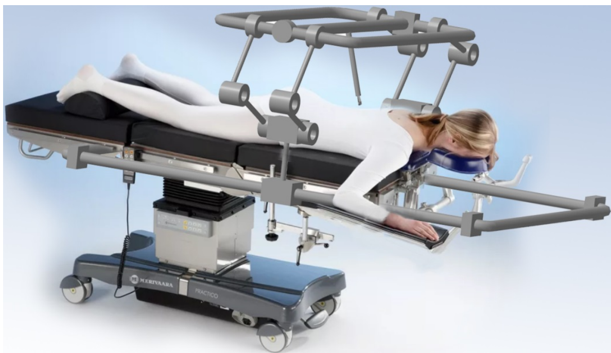
Рис. 3. Схема применения вертебрального робота параллельно-последовательной структуры
