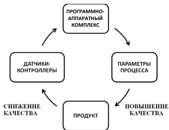
Рис. 1. Схема автоматизации технологического процесса
