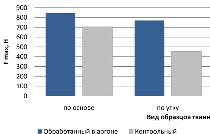
Рис. 3. Зависимость прочности джутовой ткани от режима обработки
