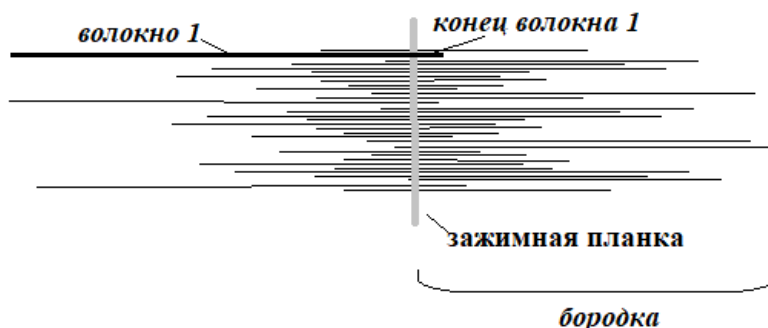
Рис. 1. Схема возможных вариантов формирования коротких концов волокон в бородке
