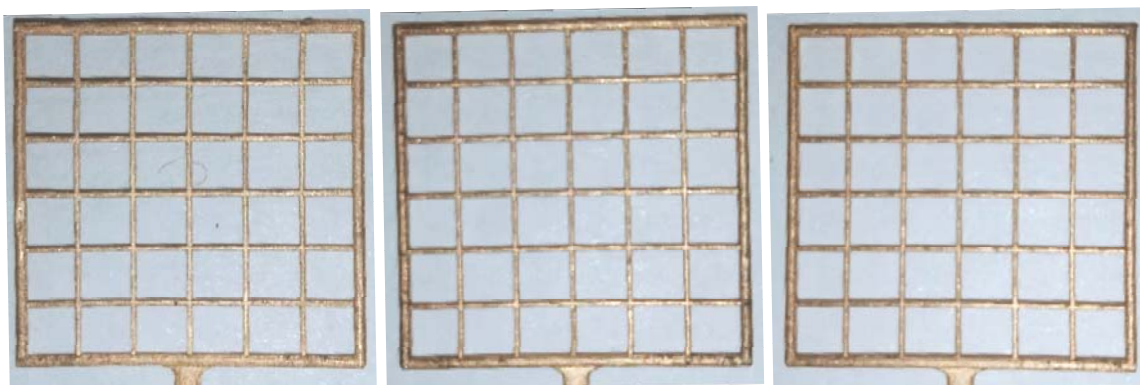
Рис. 6. Образцы из сплава золота 585 пробы красного цвета
