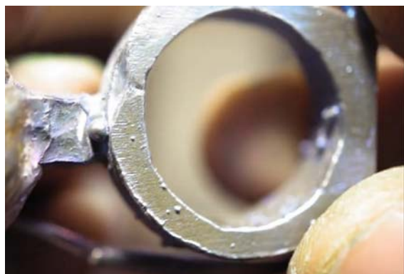
Рис. 1. Непролив кольца, связанный с недостаточным количеством заливаемого металла
