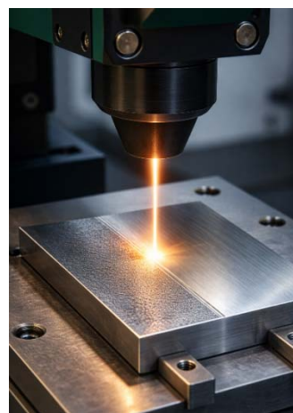
Рис. 4. Лазерная полировка (переплав)
