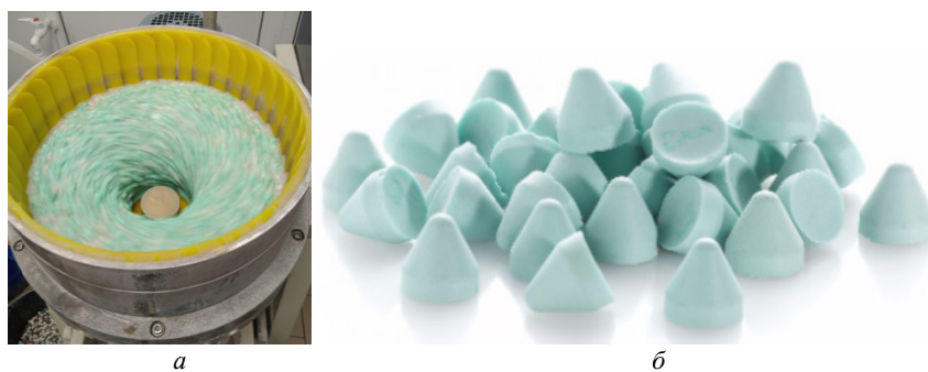
Рис. 3. Внешний вид роторной галтовочной машины (а) и пластикового наполнителя для галтовки OTEC KM10 V2095 средней абразивности (б)
