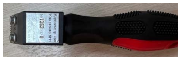
Рис. 3. Нож-адгезиметр Константа КН1
