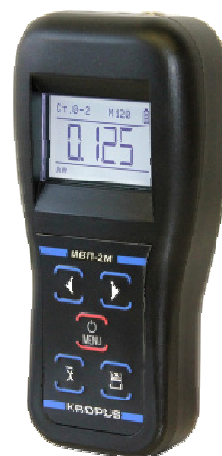
Рис. 1. Толщиномер покрытий МВП-2М
