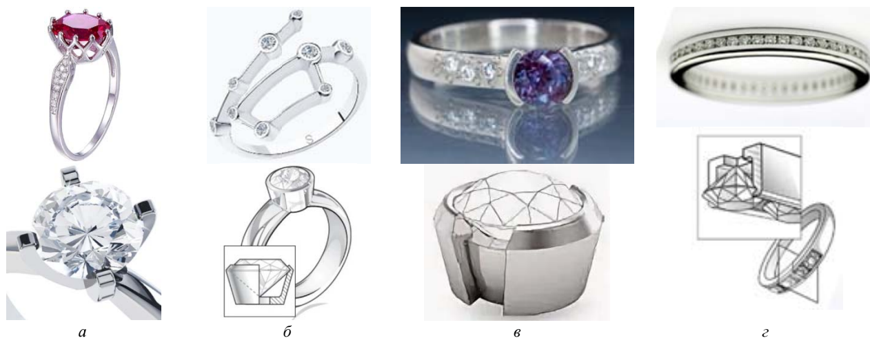
Рис. 2. Рекомендуемые виды закрепки вставок при литье с камнями:
